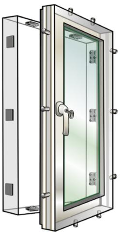
1 + 2 Pilzkopfzapfen mit Schließstück3 Gitterrostsicherung
